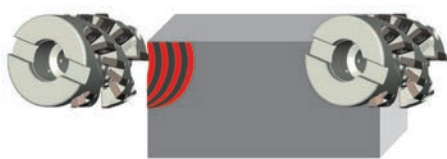
Entrée directe : grande épaisseur de copeau, risque de vibrations et d'écaillage.
