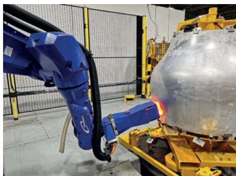
La détection de trous est réalisée sur chaque image acquise lors du déplacement du robot.
