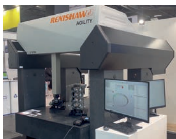
La MMT Agility bénéficie du système multi-capteurs Revo 5 axes.
